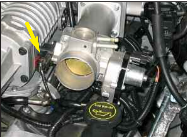
Figure AV throttle body electrical connections
